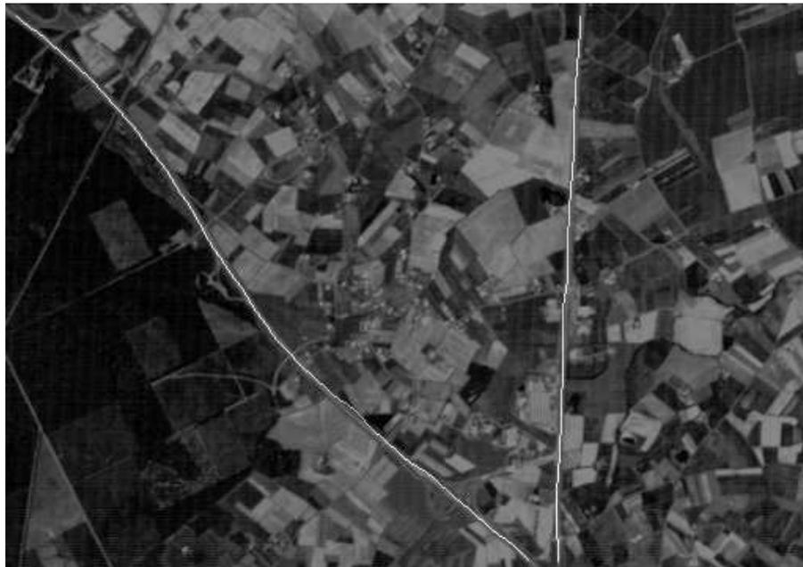
Figure 17: Illustration du résultat du suivi de route après détection des amorces.
