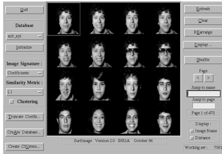
Figure 10: Résultat d’une recherche par analogie mécanique dans une base de 7562 visages. La similarité décroît de gauche à droite et de haut en bas. L’image-requête est encadrée, et seules les 15 images les plus similaires sont représentées. Notez que le système a retrouvé deux images du visage-requête portant des lunettes.
