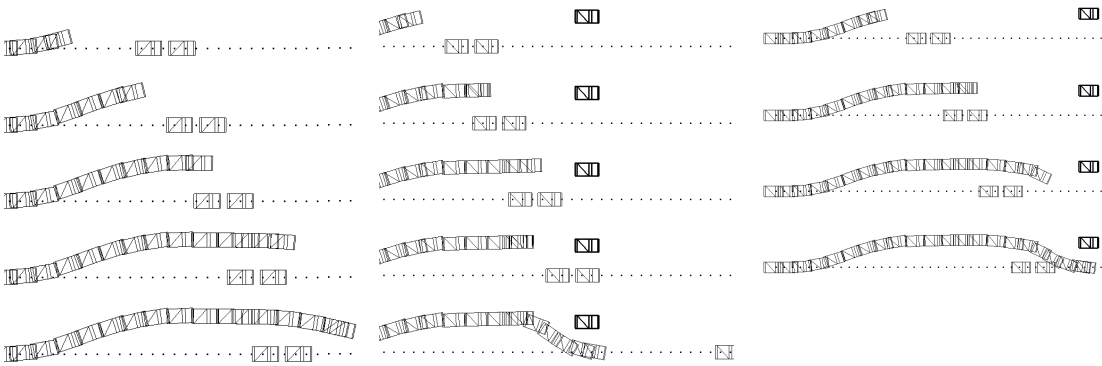
FIG. 5 – Différents contextes de dépassement de véhicules en mouvement avec et sans obstacle sur la file de gauche.
